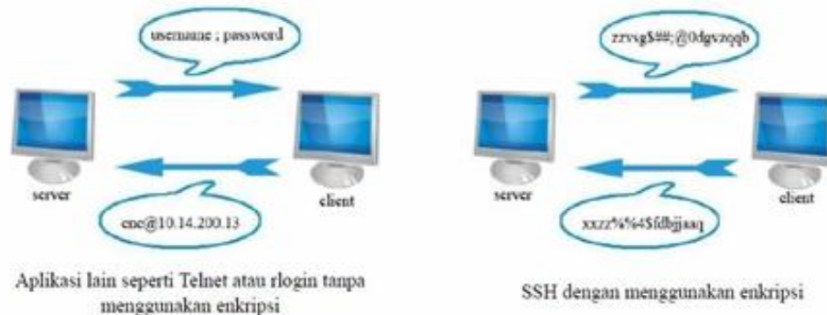
Gambar 4. Cara kerja TELNET dan SSH
